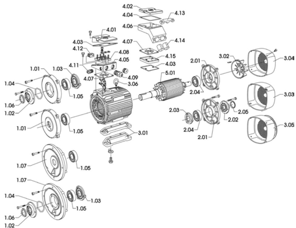
Drehstrom-Asynchronmotor mit Schleifringläufer / Grundausführung S11R / SPER / S11H / SPEH
