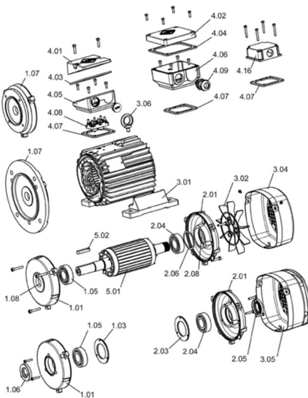
Drehstrom-Asynchronmotor / Grundausführung K1.R / K2.R 132 - 355
