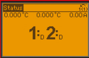
Ablese des Verdichterstatus direkt vom Display. D = Variable Drehzahlregelung, O = Aus, R = Netzbetrieb, X = Deaktiviert
