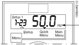
Abbildung 3.6 Anzeige der Einheit des ausgewählten Parameters
