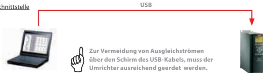
Die Verbindung zwischen Umrichter und PC wird automatisch erkannt. Das Einstellen von Parametern im Umrichter oder in der PC-Software ist nicht notwendig.
