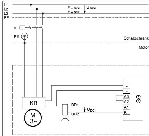
Bild 5: Wechselstromseitige Abschaltung → Klemme A2 und A3 gebrückt
