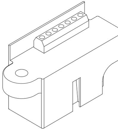
Der Durchmesser der Sensor-Bohrung zur Leiterdurchführung beträgt 7 mm. Die Durchmesser der Adern des verwendeten Motor-Anschlusskabels dürfen daher folgende Werte nicht überschreiten:
