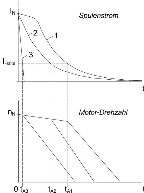
Bei gleichstromseitiger Unterbrechung werden durch die Magnetspule Spannungsspitzen  $u_q$  induziert, deren Höhe gemäß folgender Beziehung von der Selbstinduktivität  $L$  der Spule und der Abschaltgeschwindigkeit  $di/dt$  abhängt:
