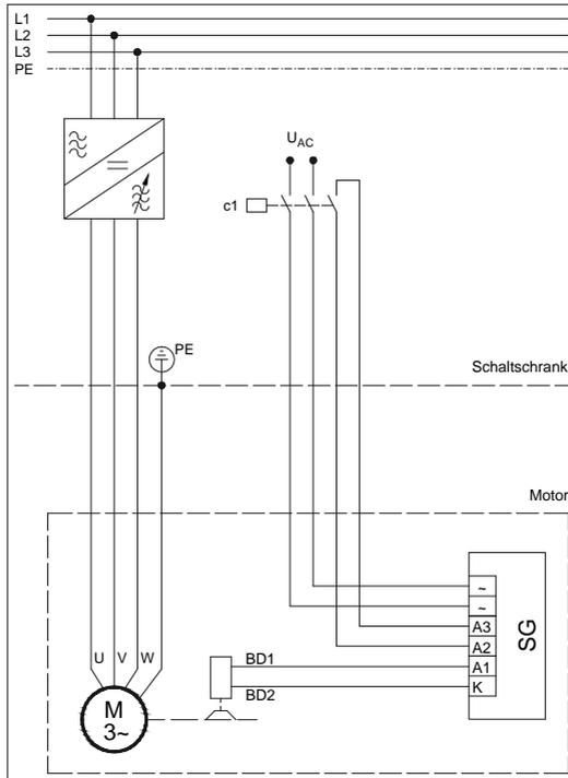
Bild 7a: Separate Spannungsversorgung des Gleichrichters.
