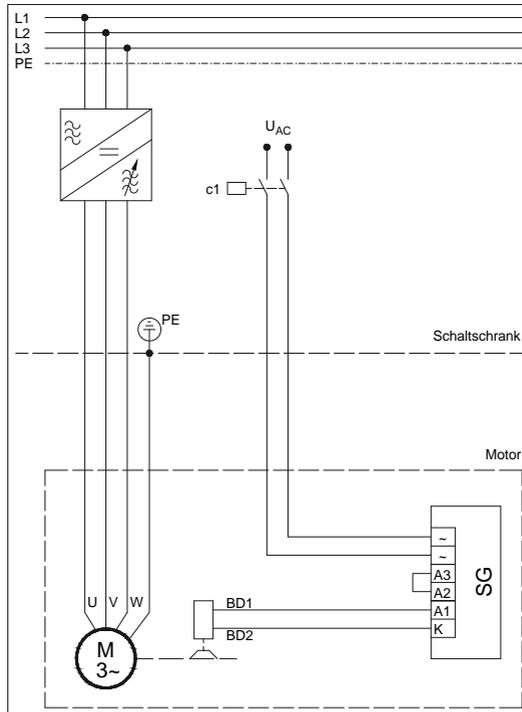
Bild 7: Separate Spannungsversorgung des Gleichrichters.
