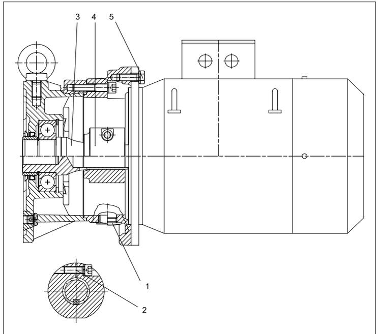
Die Schrumpfscheibe wird einbaufertig geliefert, sie sollte daher nicht auseinandergebaut werden. Die Schrumpfscheibe darf nicht ohne eingebaute Welle verspannt werden!
