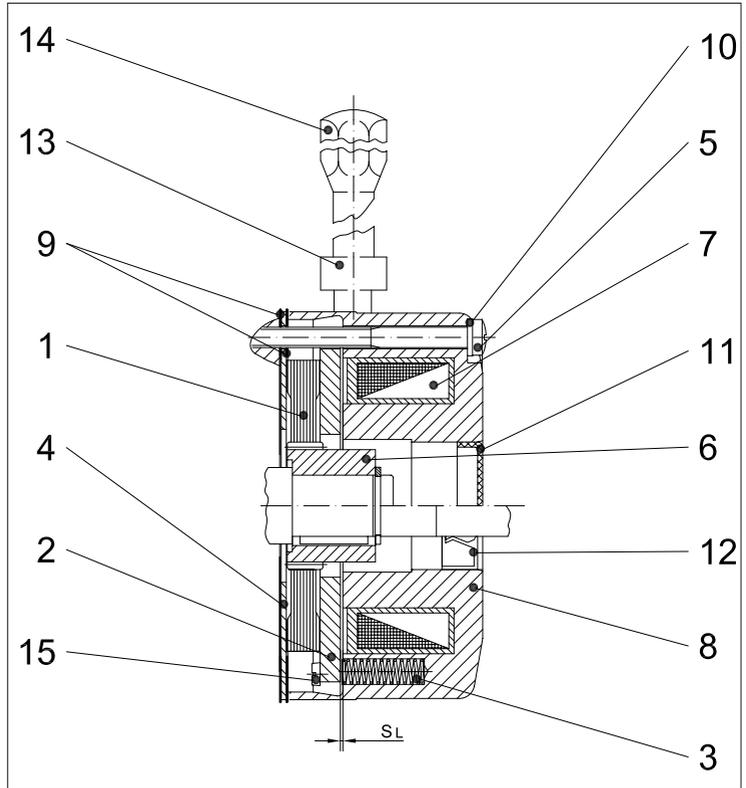
Bild 1: Federdruckbremse der Reihe E003B bzw. E004B.
