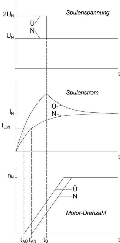
Bild 2: Prinzipieller Verlauf der Spulenspannung, des Spulenstroms und der Motordrehzahl bei Normalerregung (N) und Übererregung (Ü)
