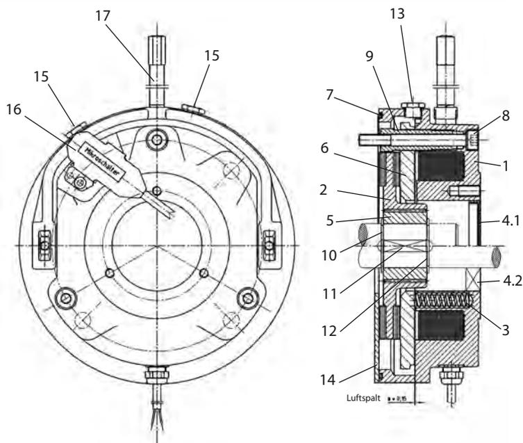
Bild 1: Federdruckbremse der Reihe ES(X)010A ... ES(X)250A.
